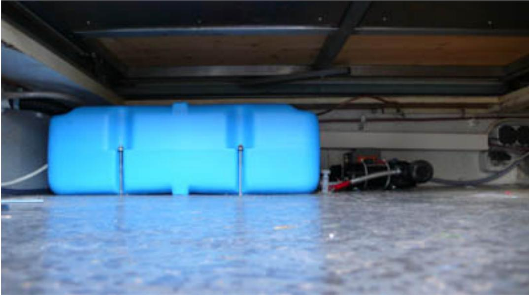
70 Liter Wassertank mit Füllstutzen außen. Druckwasserpumpe (rechts) mit 17l/min Durchfluss.
