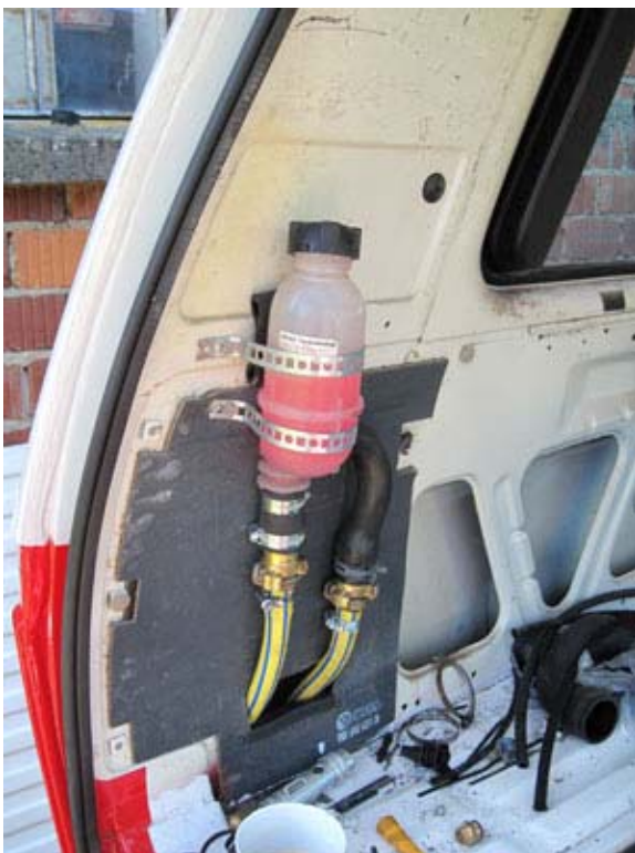
Der Ausgleichbehälter ist vom Smart. Wollte ein geschlossenes System und keinen Scheibenwischbehälter. Später ist das Ganze im hinteren Schrank.
