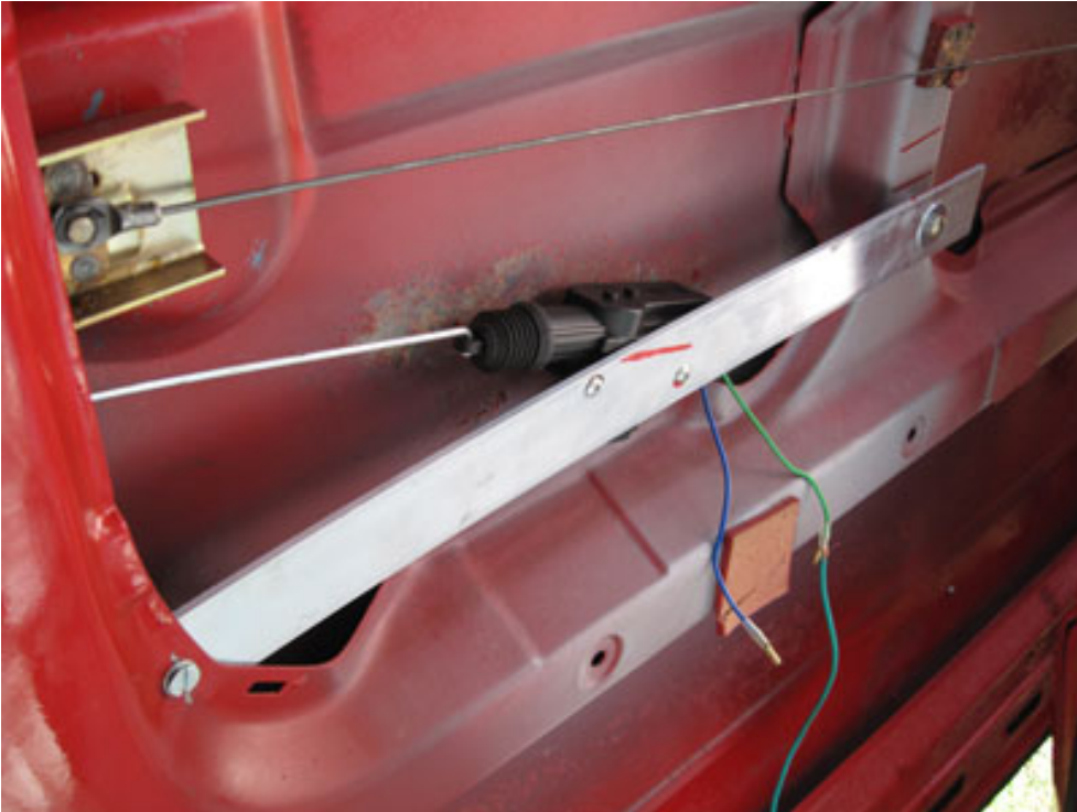
Noch ZV an der Schiebetüre nachgerüstet und ein paar Kleinigkeiten wie geschlossene Griffe...
