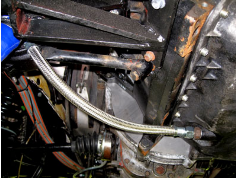
Die Ölrücklaufleitung von T3-umbau.de . Passt auch am Audi AFN.
