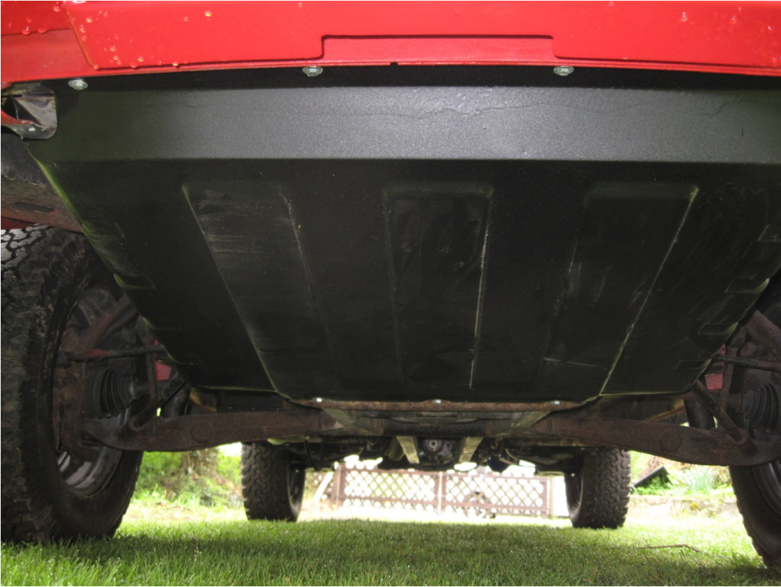
Unterfahrschutz lackiert und angebracht.
