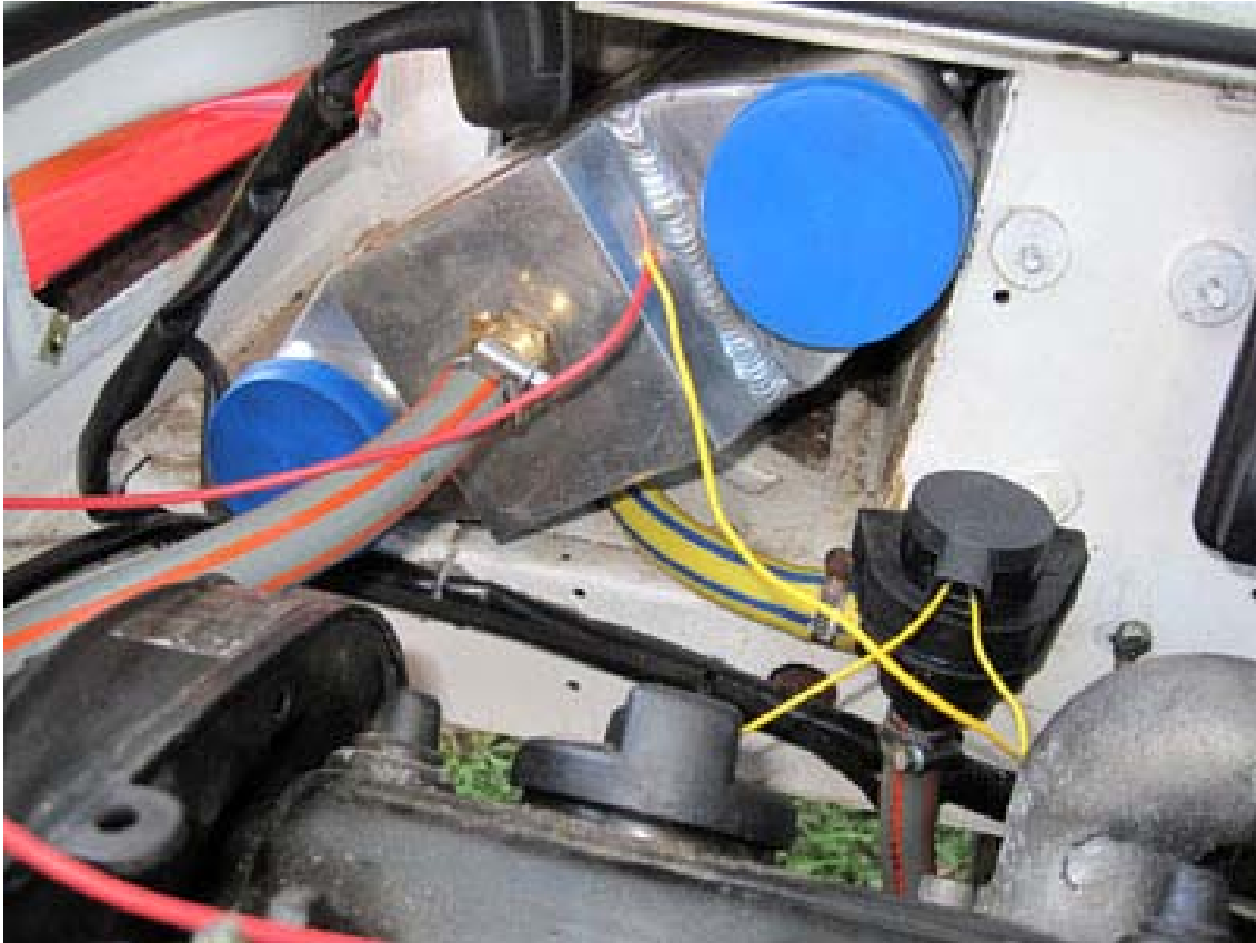
Der Ausgleichbehälter ist vom Smart. Wollte ein geschlossenes System und keinen Scheibenwischbehälter. Später ist das Ganze im hinteren Schrank.
