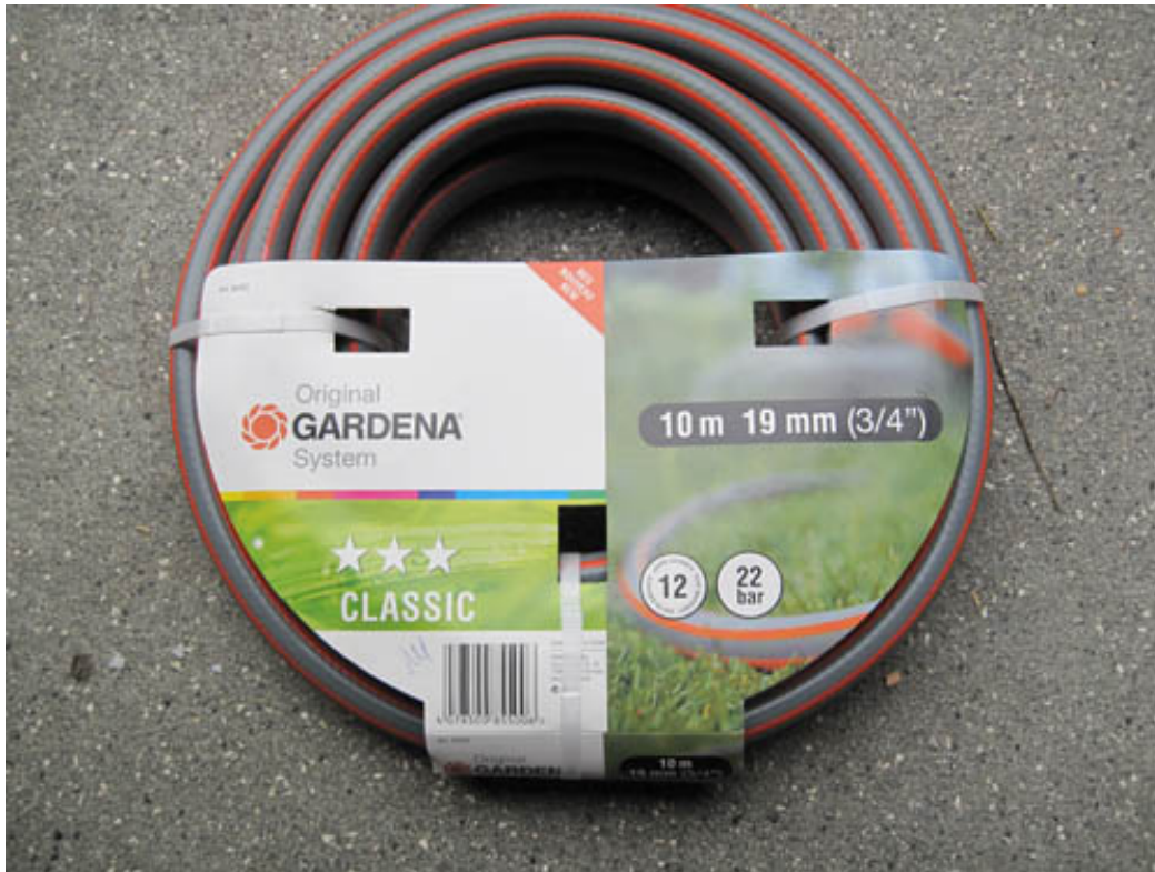
Wasserschlauch von Gardena für den Luft/Wasser Ladeluftkühler.
