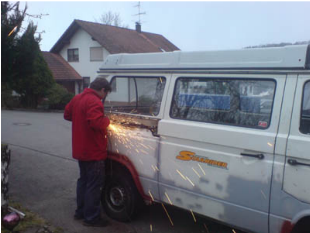
Oben: Die ganze Geschichte von innen nach der Reparatur. Unten: Komplette Schiebetürleiste rausgeflext
