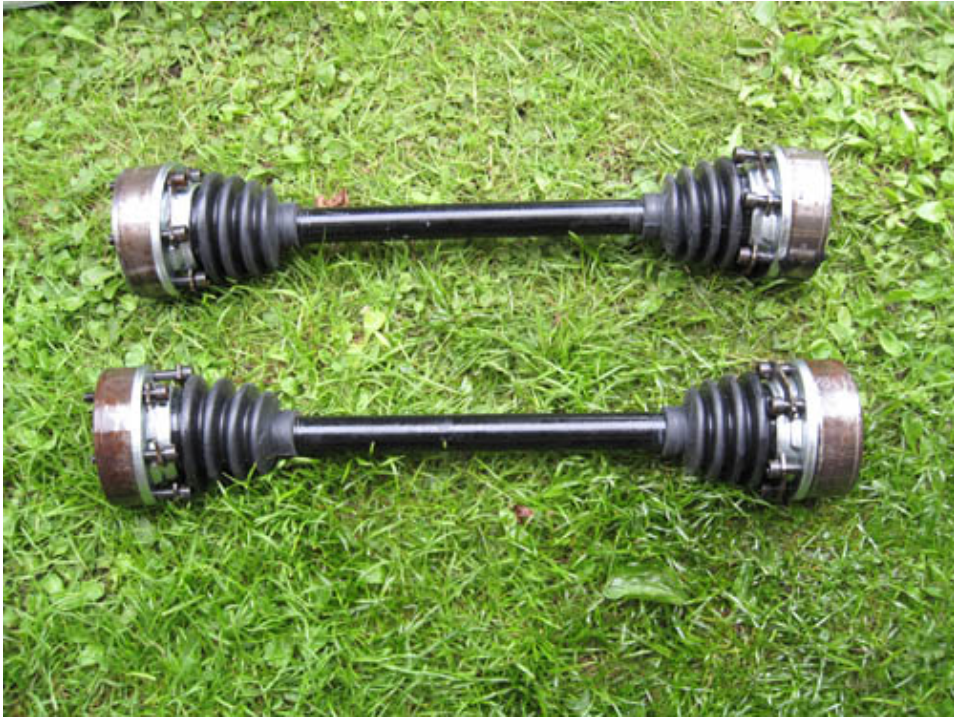
Antriebswellen entrostet und neu lackiert. Neue Manschetten.
