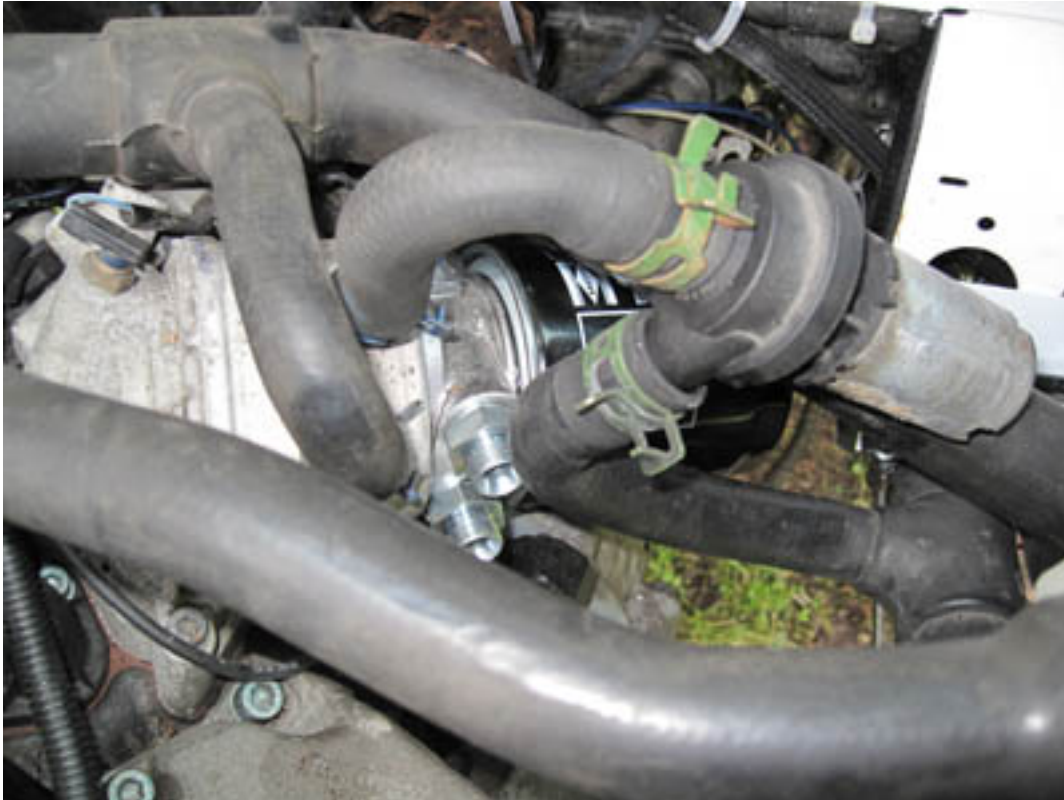
Hier die Anschlüsse vor dem Ölfilter für den Ölkühler.
